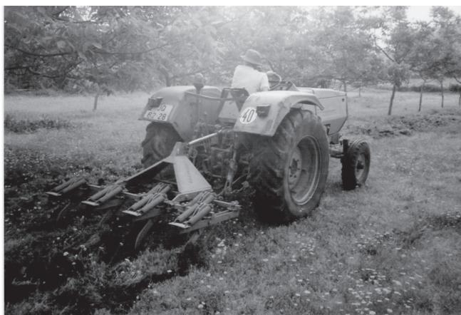
**Figura 5.4** • Abertura de sulcos com escarificador
