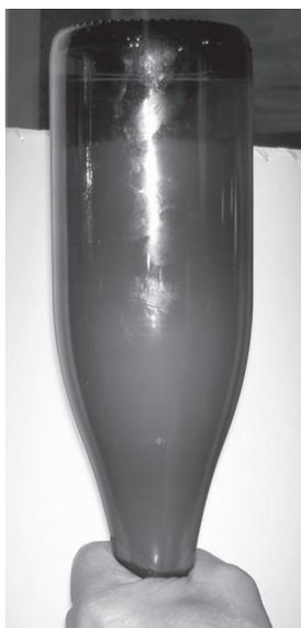
**Figura 7.3** • Garrafa invertida com as esferas concentradas no gargalo
