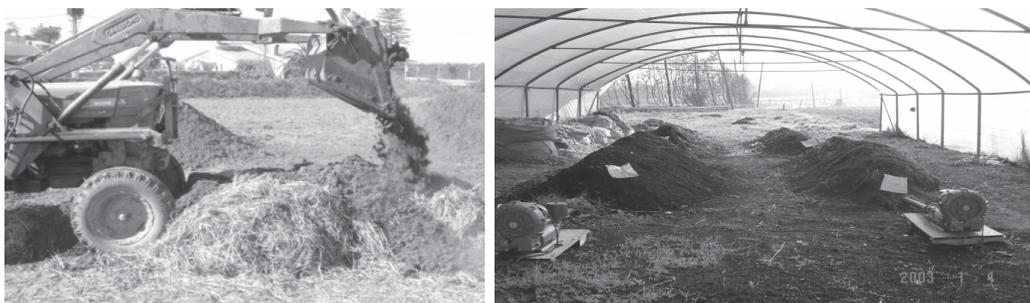
**Figura 4.7** • Sistema de pilhas a) volteio (*windrow*); b) sistema de pilhas estáticas com arejamento forçado
