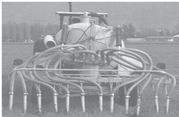
**Figura 4.1** • Semi-reboque cisterna com acessórios de enterramento por bicos de injeção. A eficiência deste equipamento tem sido melhorada pela colocação de bomba/trituradora que homogeneiza e distribui o efluente a todos os bicos
