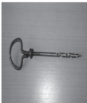
**Figura 6.2** • Verruma para abertura do furo na árvore
