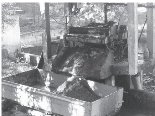
**Figura 4.4** • Máquina de separação por filtros de bandas
